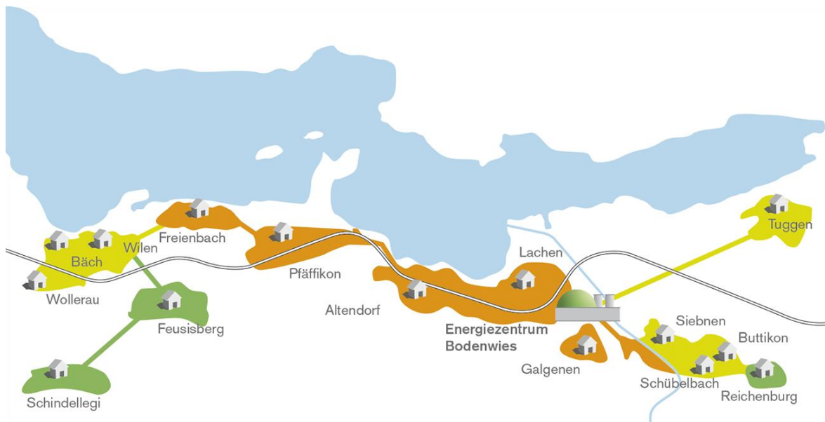
Figure 11 Extension du réseau Energie Ausserschwyz AG (1ère étape en orange, 2ème étape en jaune et 3ème étape en vert)
