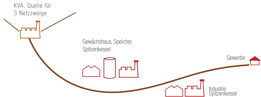
Abbildung 10-1 Skizze Netzweig mit dezentralen Spitzenkesseln und Wärmespeichern
