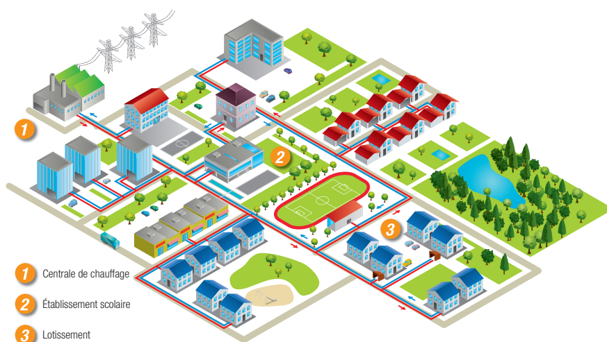
Figure 1-1 Schéma de fonctionnement du chauffage à distance
