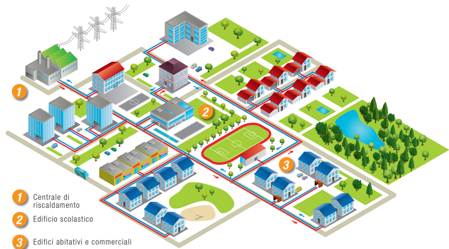
Figura 1-1 Schema di funzionamento del teleriscaldamento
