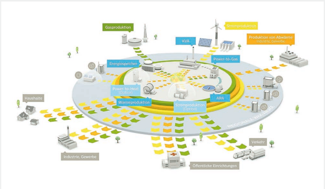
Fig. 1 Schematische Darstellung einer Sektorkopplung in einer Multi-Energie-Drehscheibe: gelb = Stromnetze; orange = Wärmenetze; grün = Gasnetze.
